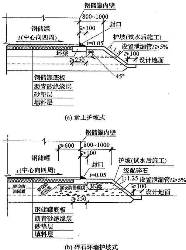
图 3.2.3-1 护坡式基础
