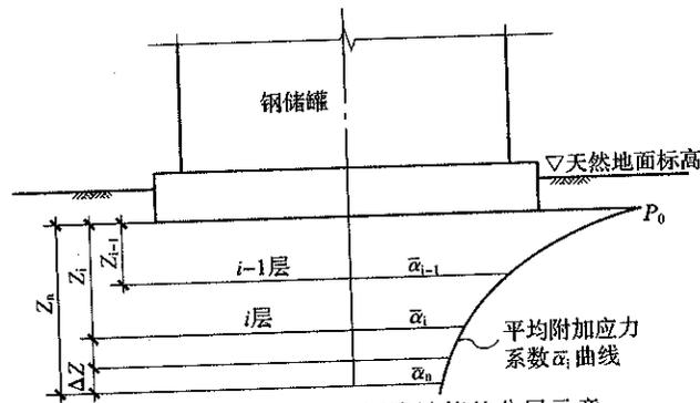
图 6.2.2 储罐基础沉降计算的分层示意
