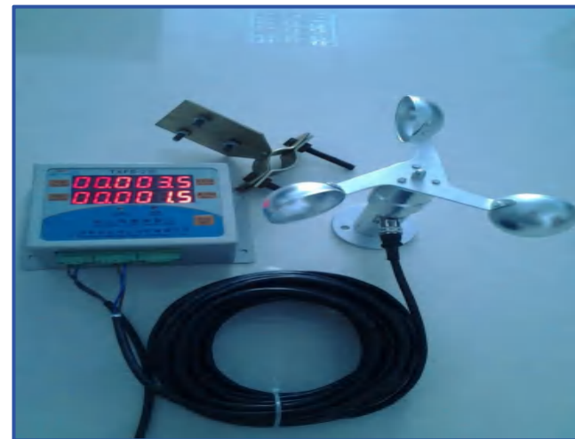
图9-56 风速仪及风速报警装置
