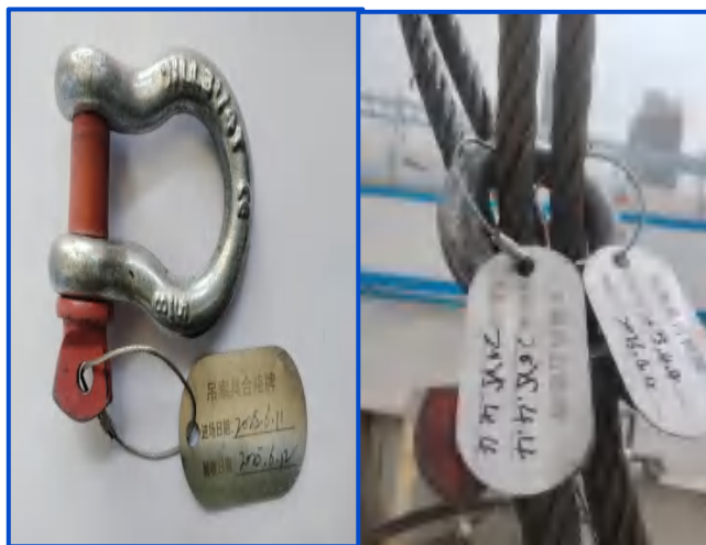
图5-42 吊索具检查合格挂牌
