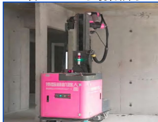
图10-56 螺杆洞封堵机器人
