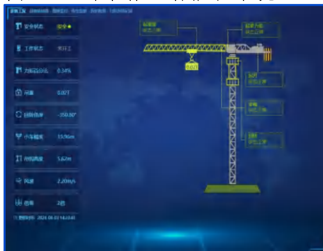
图5-40 塔机数据实时监控系统
