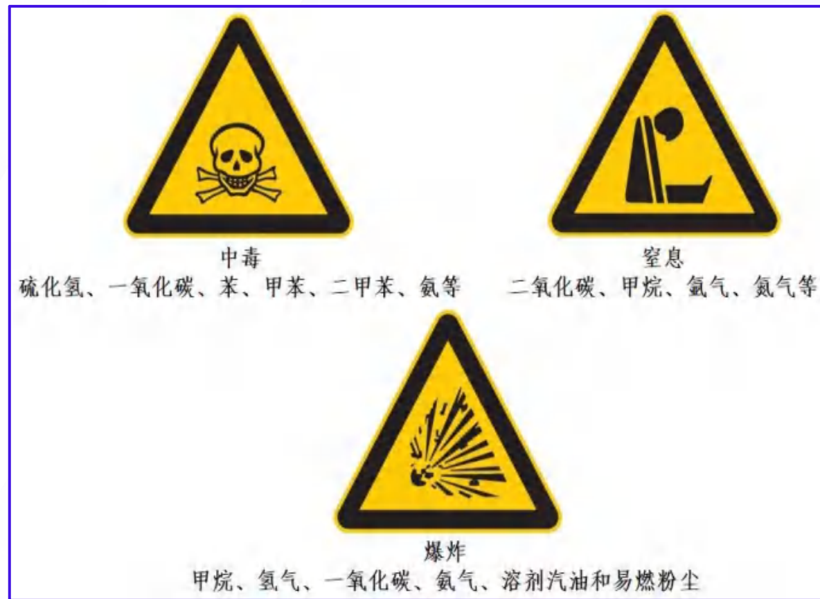
图8-2 有限空间作业常见的危险有害因素
