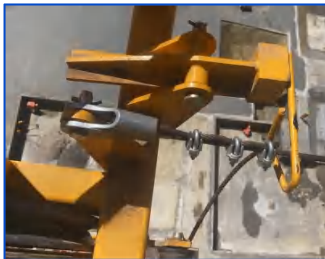
图5-19 小车断绳保护装置
