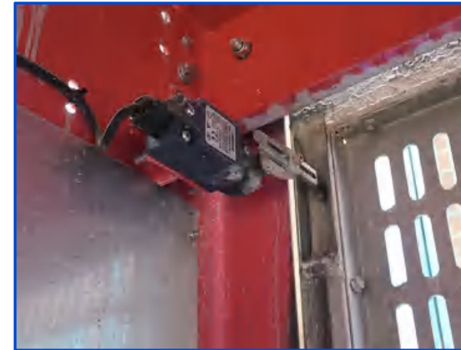
图5-63 吊笼笼门电气限位
