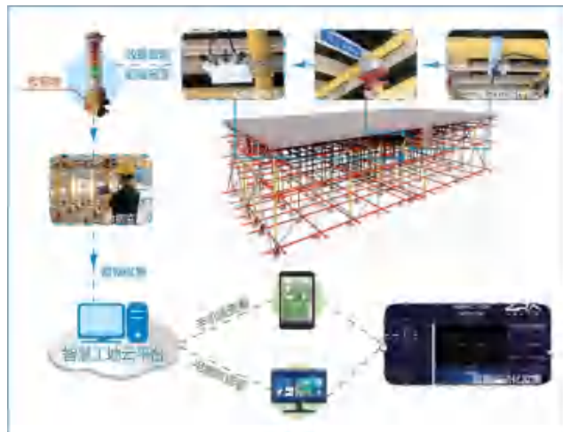
图10-45 高支模安全监测系统
