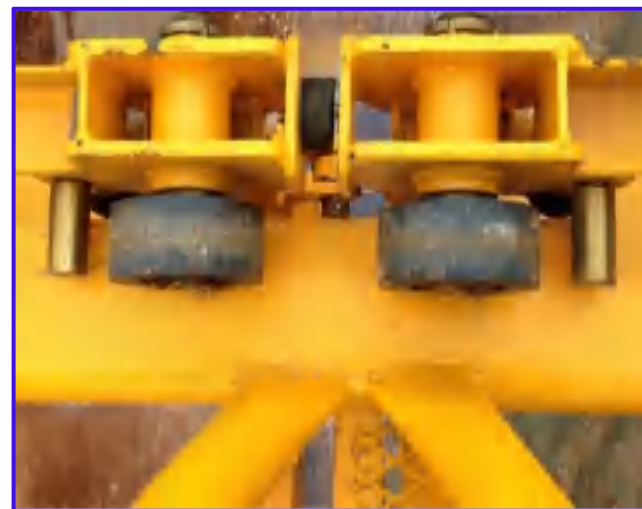
图5-20 小车断轴保护装置
