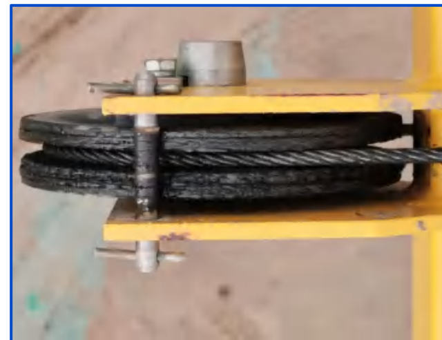
图5-24 钢丝绳防脱装置
