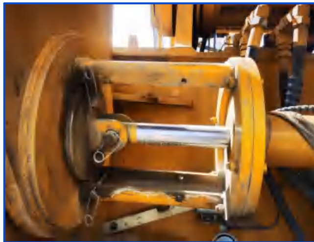
图5-87 油缸防脱装置
