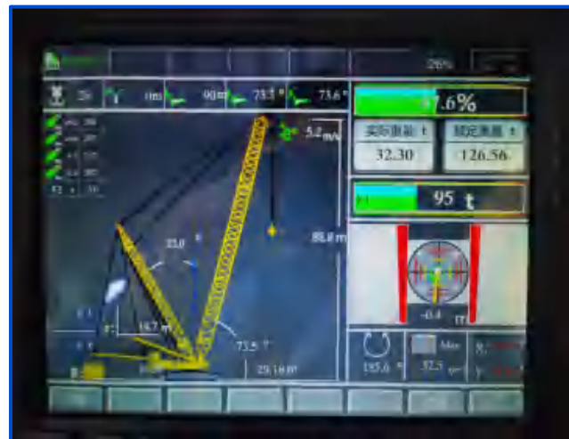
图5-95 吊装数据实时显示
