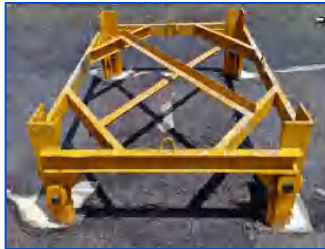
图5-2 塔机基础预埋件
