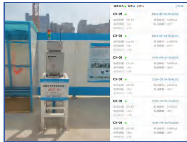
图1-38 深层水平位移监测机器人
