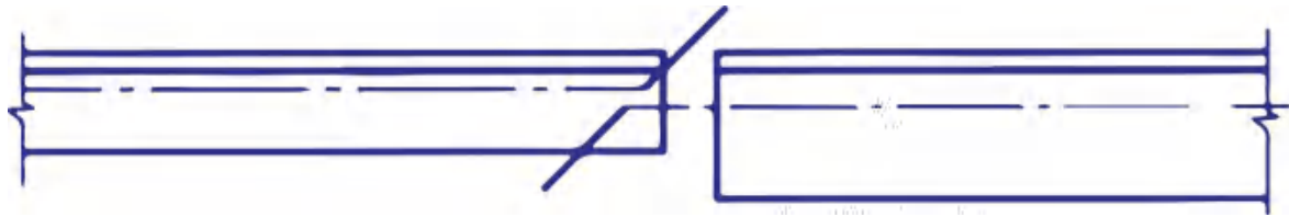
图 1-16 两构件重心线不重合的表示方法
