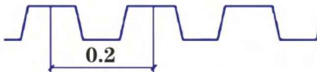
图某压型钢板楼板部分示意图.
