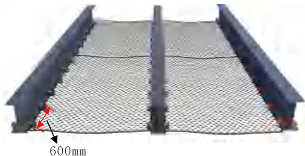
H型钢梁下挂式安全网挂设效果图
