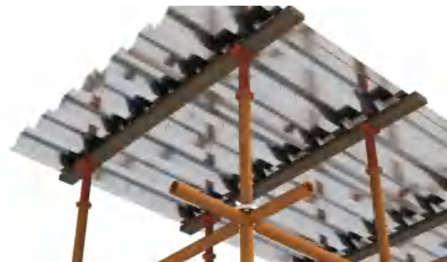
图17.2 顶部支撑示意图
