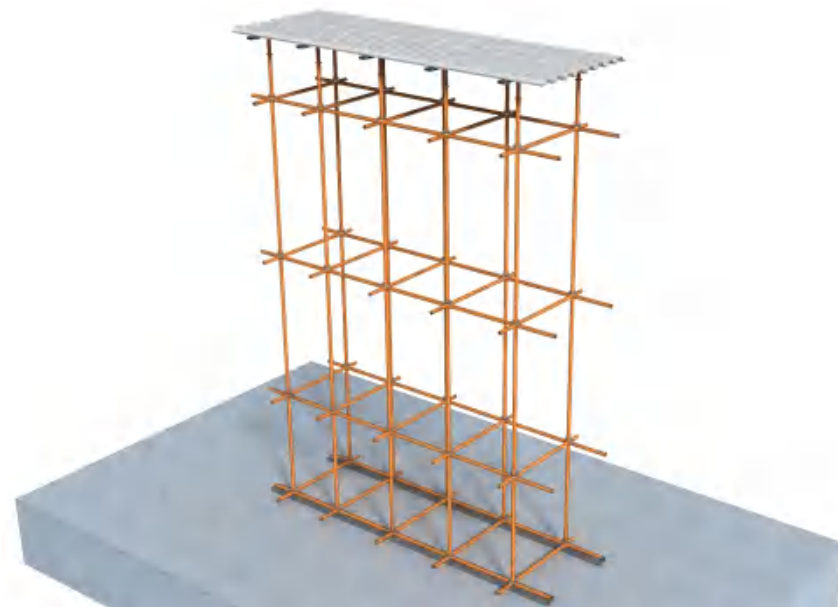
图17.1 盘扣式脚手架支撑示意图
