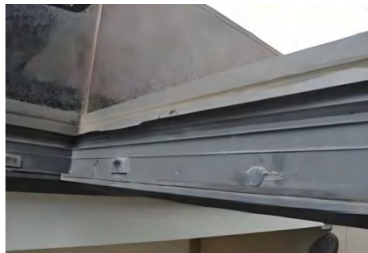
工艺孔盖打密封胶
