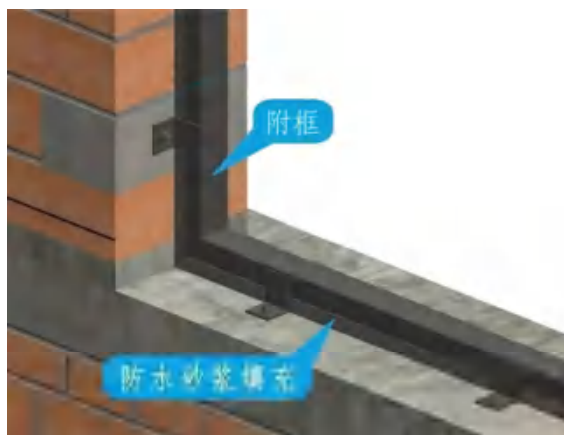
下口间隙采用防水砂浆填充
