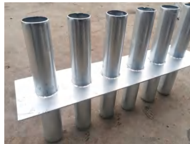
钢板焊接群管
