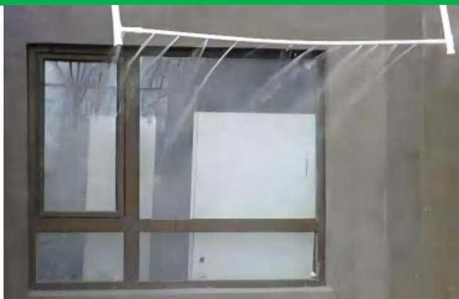
建筑外窗淋水试验
