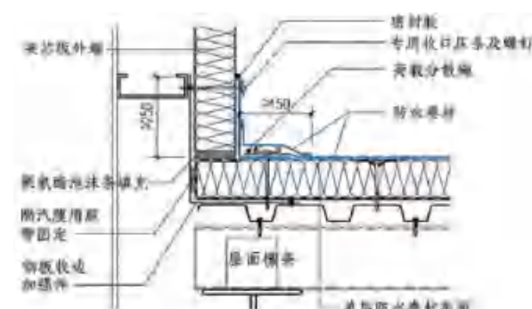
单层防水卷材屋面山墙防水构造
