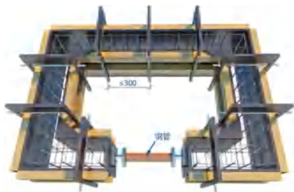
涉水房间混凝土坎台吊模示意图
