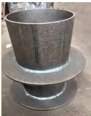
穿越底板的降水井采用防水套管
