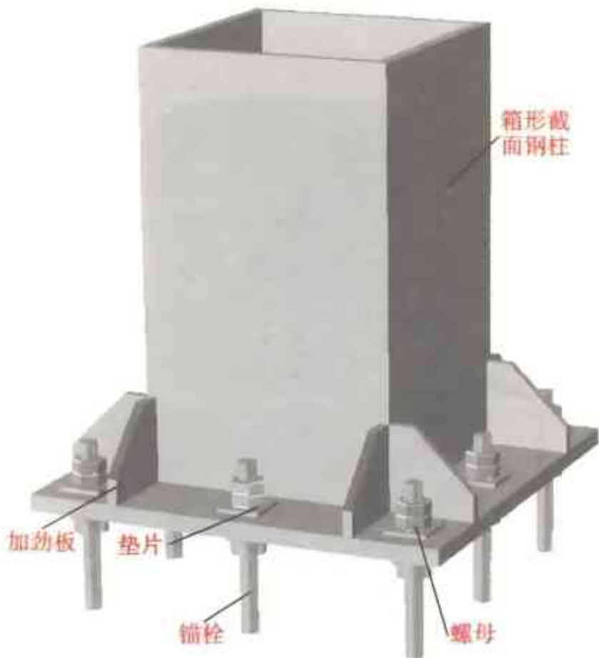
图 2-21 箱形截面柱铰接柱脚构造（一）三维图
