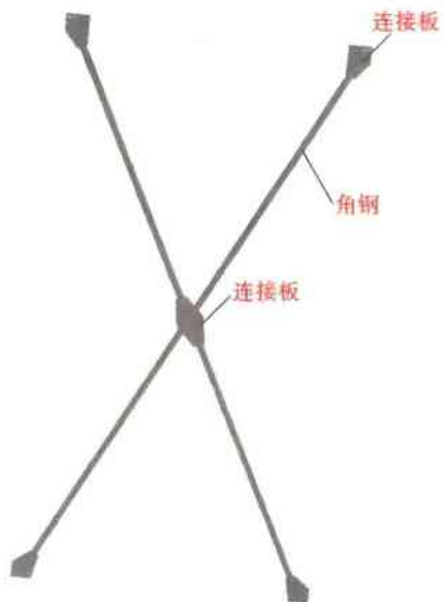
图 2-219 上弦横向支撑 (六) 三维图
