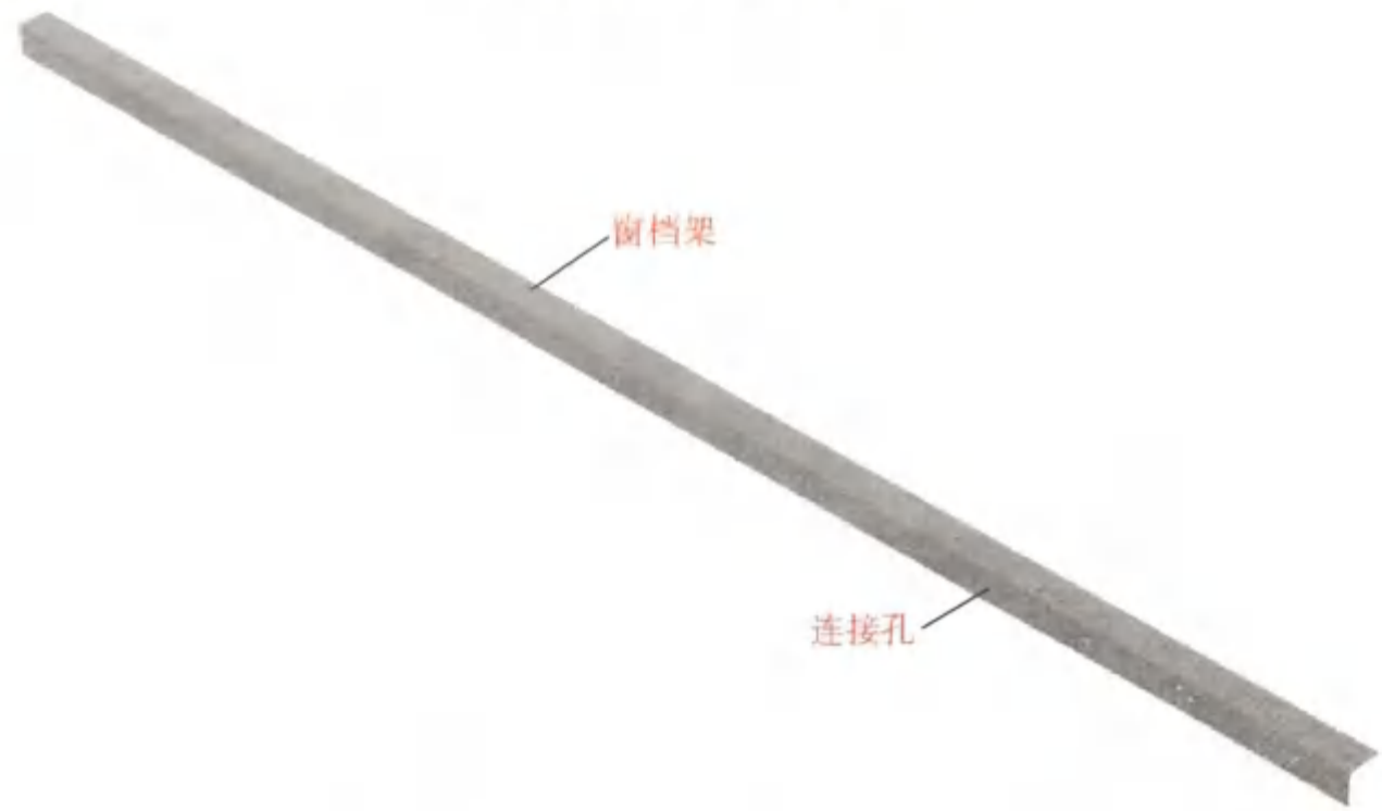
图 2-401 窗下档详图（三）三维图
