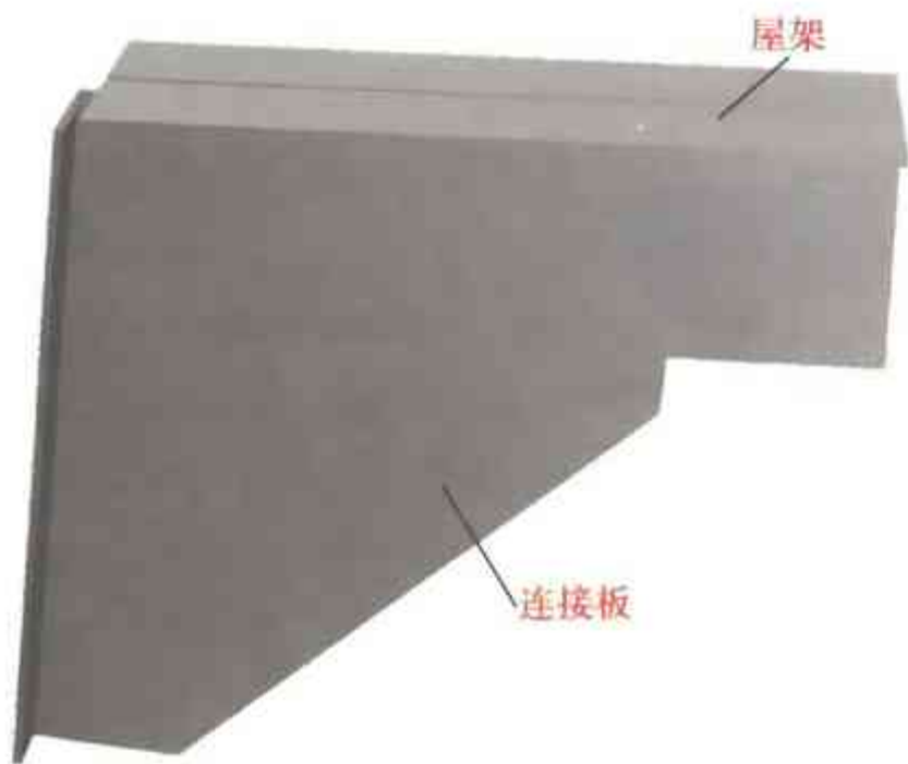
图 2-194 屋架节点 (四) 三维图
