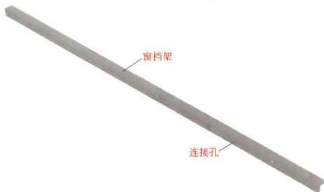
图 2-399 窗下档详图 (二) 三维图
