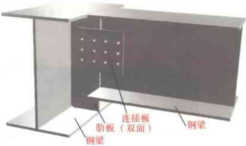
图 2-135 梁-梁铰接标准做法三维图
