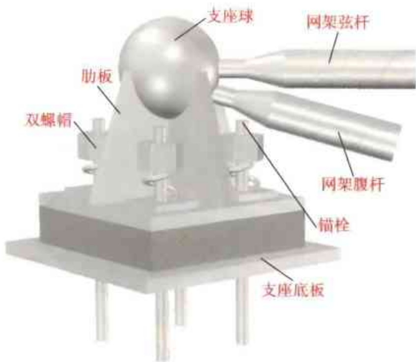
图 2-328 板式橡胶支座节点三维图
