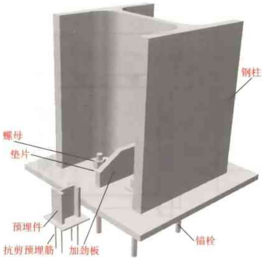
图 2-31 外露式柱脚抗剪键的设置 (二) 三维图
