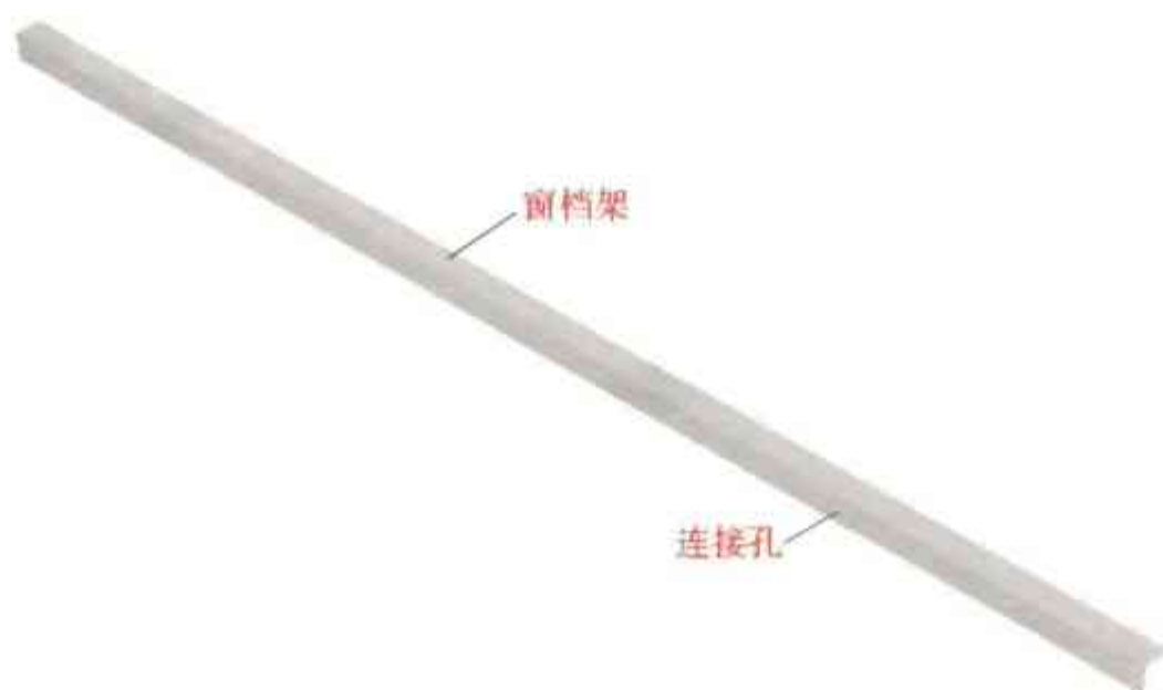
图 2-397 窗下档详图 (一) 三维图
