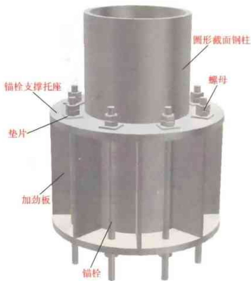
图 2-19 圆形截面柱铰接柱脚构造（二）三维图
