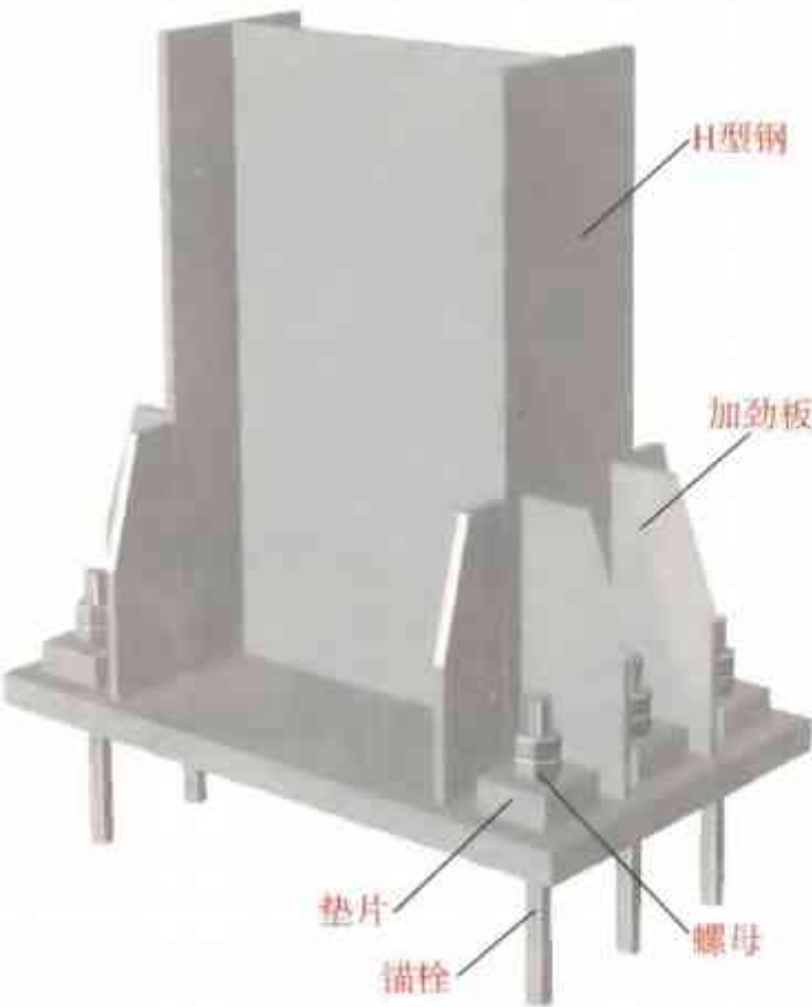
图 2-7 柱脚刚接做法三维图
